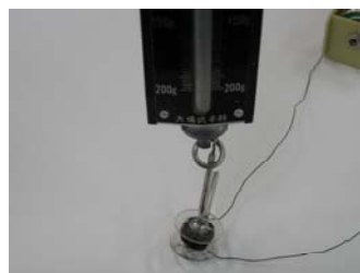
ばねはかりで磁力を測る
