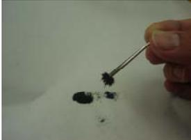
砂鉄を引きつけた時の条件・・・砂鉄の中に布団針を入れ
